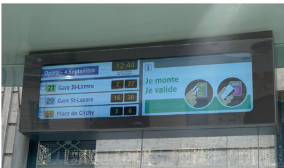
Affichage dynamique en couleur des temps d'attente sur le réseau de bus du STIF permettant un bon contraste (source : ©RATP)
